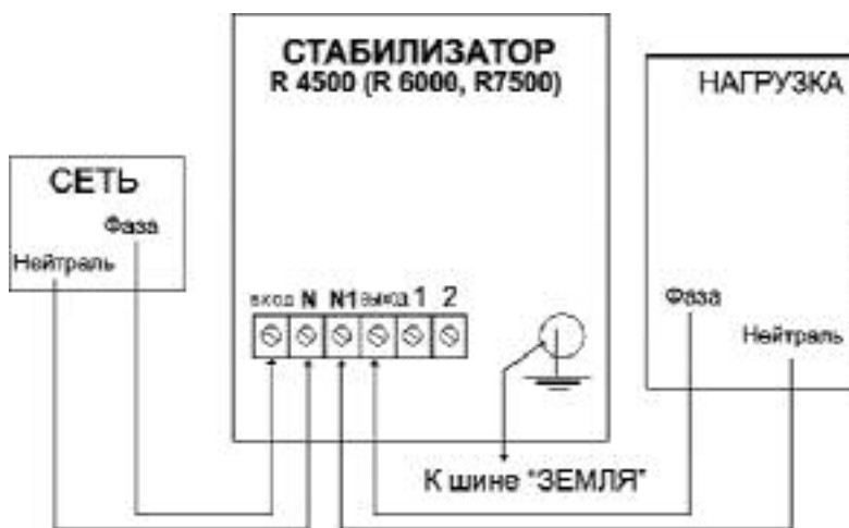
Рис. 3. Схема подключения стабилизатора
